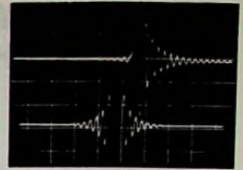
Naaldimpulsen. Boven Sony DAT recorder en onder CD-speler met 4-voudige oversampling.
