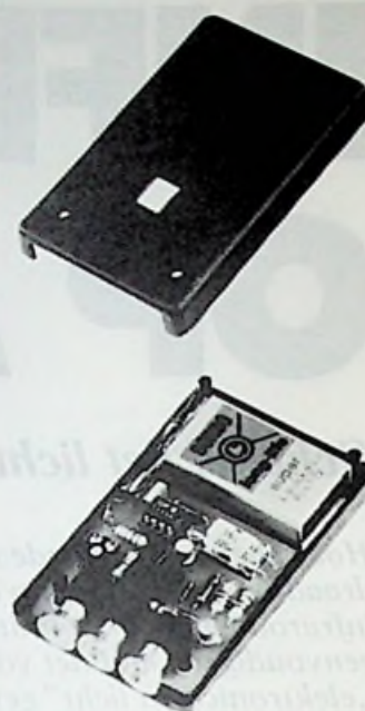
Afb. 5. En zo past de zender samen met een 9V-batterijtje precies in het handzame kastje!
