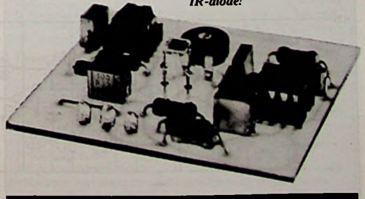
Afb. 9. De versterker ten voete uit, let op de montage van de IR-diode!
